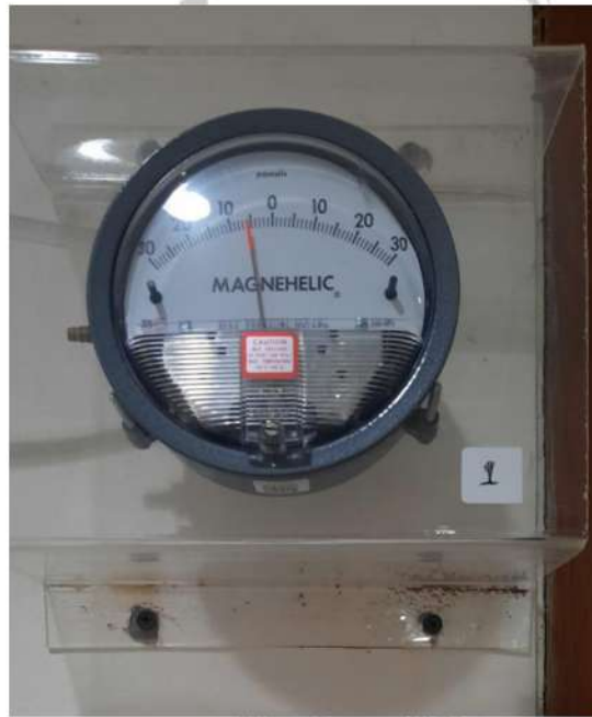
Gambar 13: Magnehelic Kamar isolasi, Tekanan -5 Pascal Sumber: dokumen pribadi
